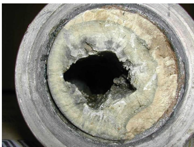
Сурет №4 және №5. Құмкөл кен орнының тұз шөгінділерінің ұңғымадағы бейнесі
