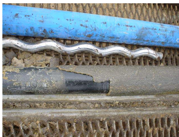
Сурет №4 және №5. Құмкөл кен орнының тұз шөгінділерінің ұңғымадағы бейнесі
